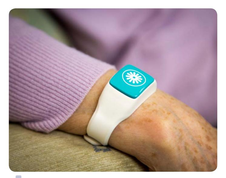
Das induktive Laden erspart z. B. älteren Menschen das zu komplexe Einfädeln eines kleinen Steckers in eine Buchse. Der Nutzer kann das Gerät zum Aufladen einfach auf ein solches Ladegerät, z.B. eine Ladescheibe, auflegen.
